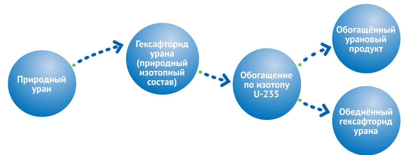
Схема разделения изотопов урана
